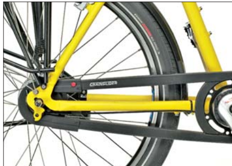
Clever und klapperfrei: Der Rundum-Kettenschutz von Hebie „schwimmt“ auf der Kette. Trotzdem hört man ihn nicht.
