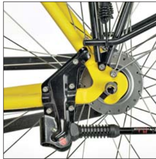
Günstig und knifflig: Die Hinterachse muss beim Rad-einbau genau justiert werden.
