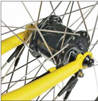
Gut und teuer: Die Lichtmaschine von SON, in der Sonderfarbe Schwarz eloxiert.
